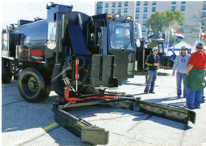
Selbstfahrer mit weit ausladendem Gülfahrer. Für den Einsatz in sehr großen Ställen.
