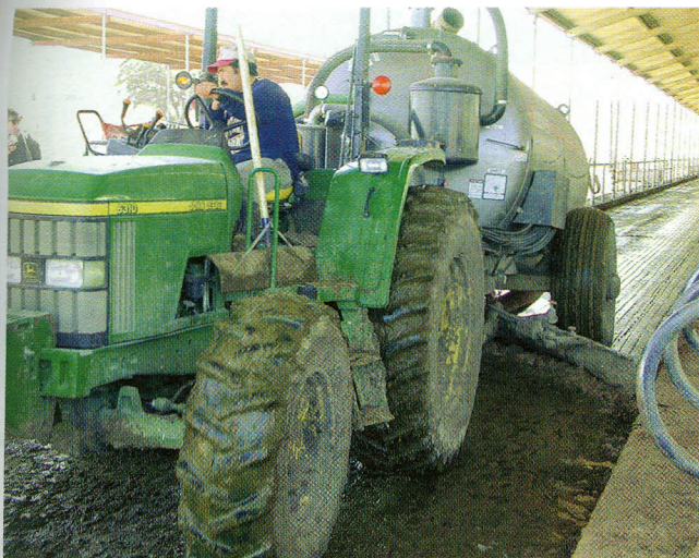
„Güllesauger“ am Schlepper angehängt. Das Fassungsvermögen beginnt bei 4,5 m 3 .
