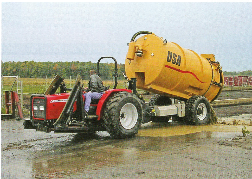
Selbstfahrende Güllesauger sind sehr wendig, sie sind deshalb für den Einsatz in mehreren Stallabteilen geeignet. Zum Entleeren kann das Fass sogar angekippt werden.
